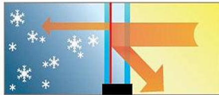
冬季： 室內的熱能因Low-E雙層玻璃的阻斷 而不易輻射至室外，而能保暖。
