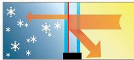
冬季： 室內的熱能因LOW-E雙層玻璃的阻斷 而不易輻射至室外，而能保暖。
